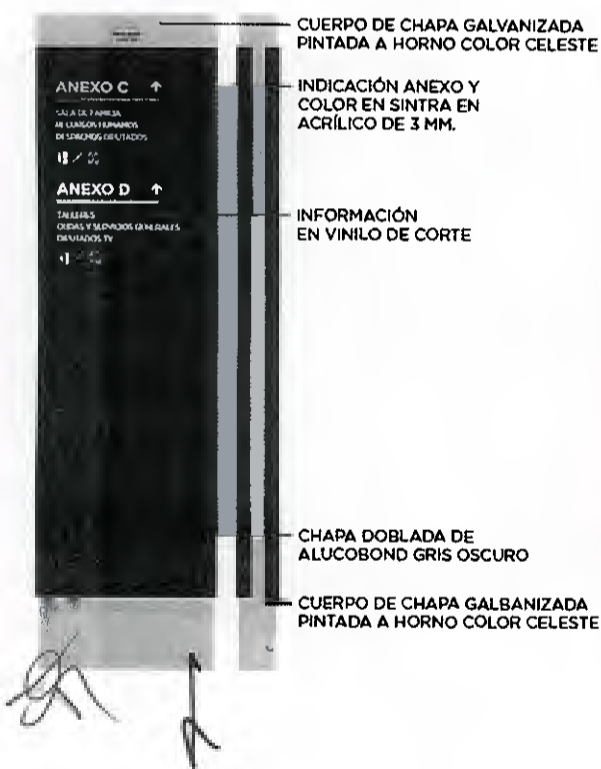
CUERPO DE CHAPA GALVANIZADA 1,56 MM. PINTADA DE CELESTE INSTITUCIONAL CON FIJACIÓN AL PISO MEDIANTE BULONES. 200 X 50 X 15 CM.
